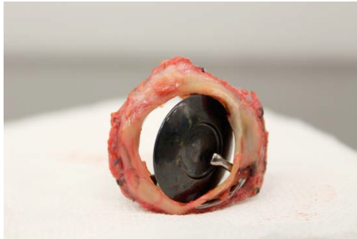
Рис. 11. Нарастание паннуса на дисковом протезе
